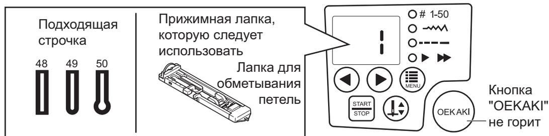
Петля будет выполнена автоматически в порядке следования номеров, приведенных на рисунке.
