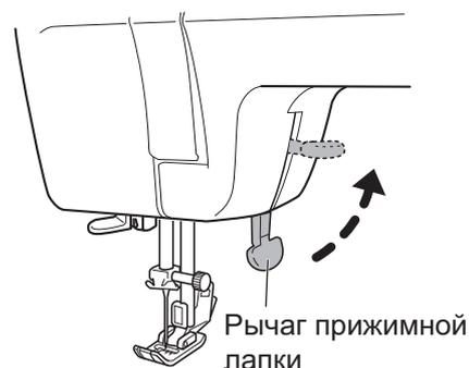
**3** Поверните маховик по направлению к себе, чтобы поднять рычаг нитепритягивателя в самое верхнее положение. Можно также до выключения швейной машины на шаге 1 нажать кнопку
