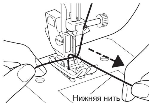
**4** Выровняйте обе нити, пропустите их через прорезь в прижимной лапке, а затем под ней и вытяните нить примерно на 15 см по направлению к задней стороне машины.
