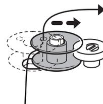
Индикаторы на дисплее последовательно мигают, указывая, что производится намотка шпульки.
