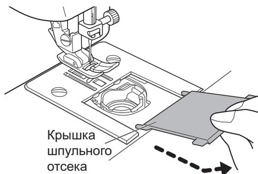
**3** Вставьте шпульку в шпульный колпачок таким образом, чтобы шпулька при разматывании нити вращалась против часовой стрелки.
