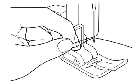
**6** Проведите нить через прорезь в прижимной лапке и вытяните нить примерно на 15 см в направлении задней части швейной машины.
